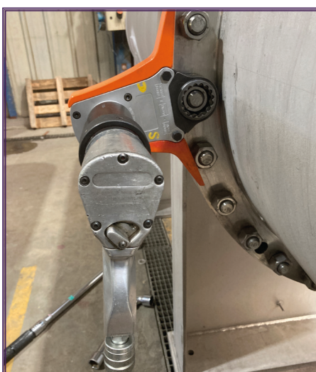
Cartouche de déport pour JGUN A0.5 et A1, LGX-1000, LIONGUN-.7, LST-0700 et LST-1200 - Carré de 3/4" - Référence : OL1-A0100
