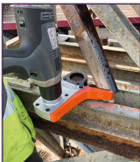
Cartouche de déport pour JGUN A0.5 et A1, LGX-1000, LIONGUN-.7, LST-0700 et LST-1200 - Carré de 3/4" - Référence : OL1-A0100
