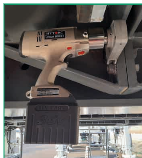
Cartouche de déport pour J-GUN A0.5 et A1, AVANTI 1, ICE 1, LGX-1000, LIONGUN-.7, LST-0700 et LST-1200 - Carré de 3/4" - Référence : OL1-A0100
