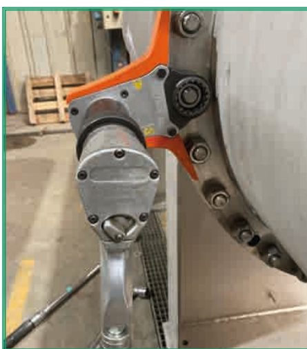
Cartouche de déport pour J-GUN A0.5 et A1, AVANTI 1, ICE 1, LGX-1000, LIONGUN-.7, LST-0700 et LST-1200 - Carré de 3/4" - Référence : OL1-A0100
