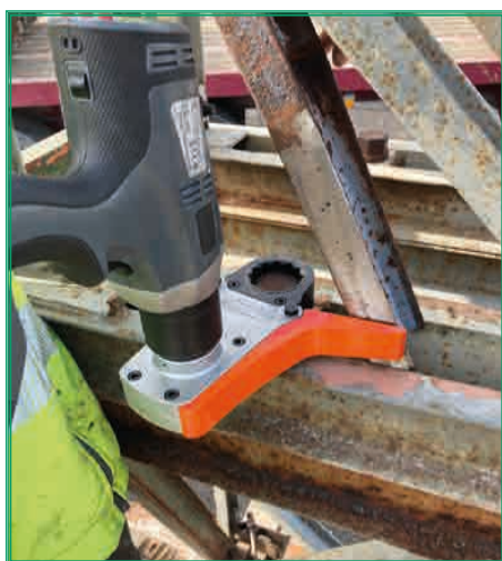
Cartouche de déport pour J-GUN A0.5 et A1, AVANTI 1, ICE 1, LGX-1000, LIONGUN-.7, LST-0700 et LST-1200 - Carré de 3/4" - Référence : OL1-A0100
